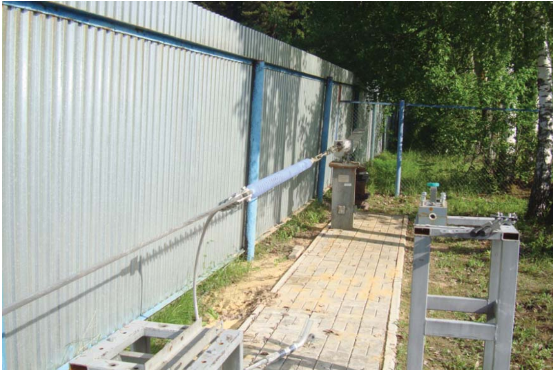
Рис.8. Изолятор ЛК120/110 на испытательном стенде (натяжная подвеска)
