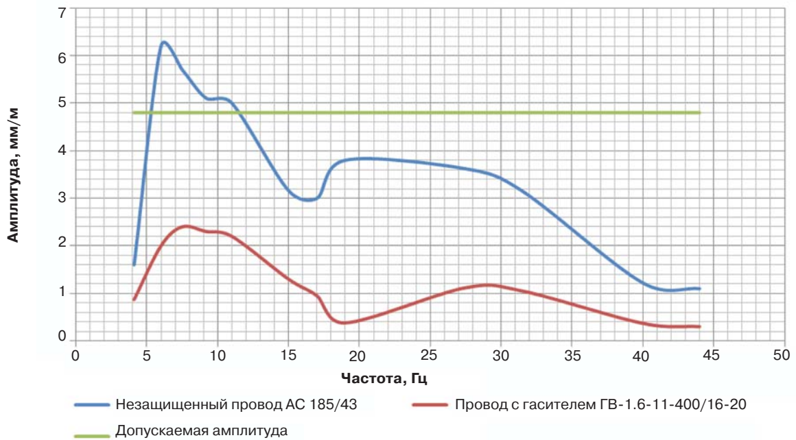
Рис. 9. Амплитуда колебаний изолятора при анкерном креплении.
