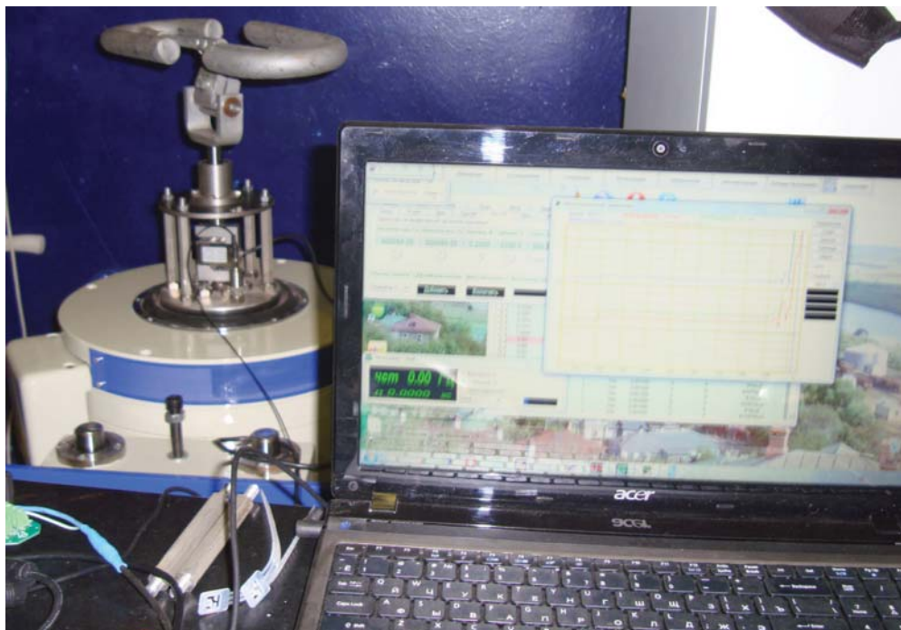
Рис.2. Система испытательная вибрационная электродинамическая ES -1-150/DA-1.
