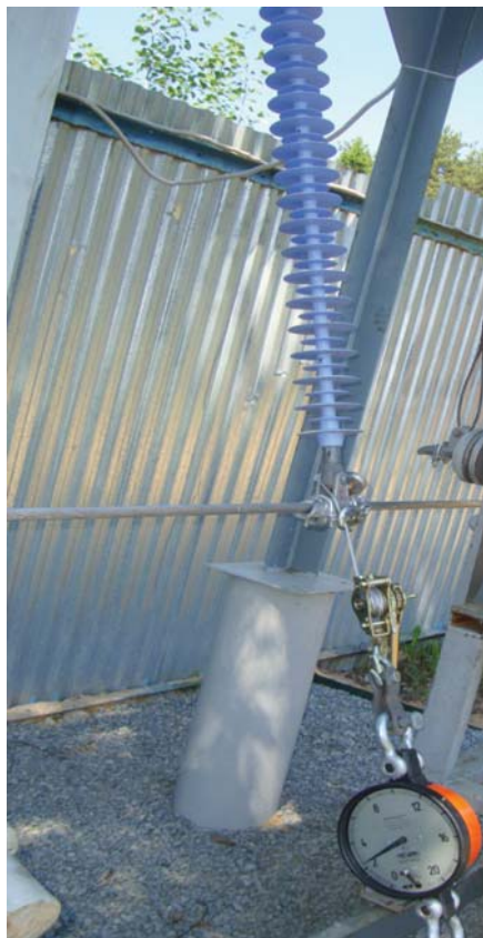
Рис. 10. Изолятор ЛК-120/110 на испытательном стенде (поддерживающая подвеска)
