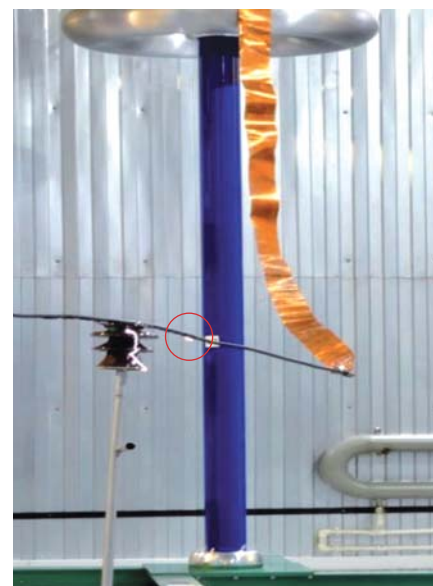
Рис. 1. Моделирование процессов перекрытия изоляторов под воздействием индуктированных напряжений (качество фотографий ограничено возможностью сканкопии протоколов испытаний)
