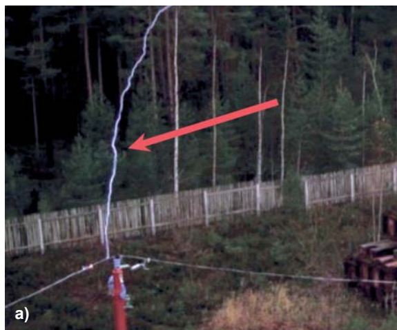
Рис. 3. Воздействие грозового импульса: а) на провод СИП-3 линии 10 кВ с установленным на опоре УЗПН-10-ОЛ; б) пробой искрового промежутка УЗПН-10-ОЛ (качество фотографий ограничено возможностью сканкопии протоколов испытаний)
