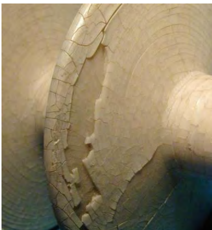
Рис. 7. Дефекты на внешней поверхности защитной оболочки изоляторов I поколения
