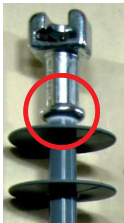
Рис. 10. Недостаточная герметичность границы раздела между оболочкой изолятора и оконцевателем
