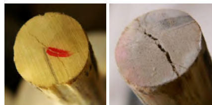
Рис. 14. Скрытые повреждения стеклопластикового стержня при опрессовании оконцевателей в процессе сборки изолятора
