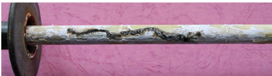
Рис. 12. Образование «дендритов» в стеклопластиковом стержне и трещин на границе раздела «стержень – оболочка»
