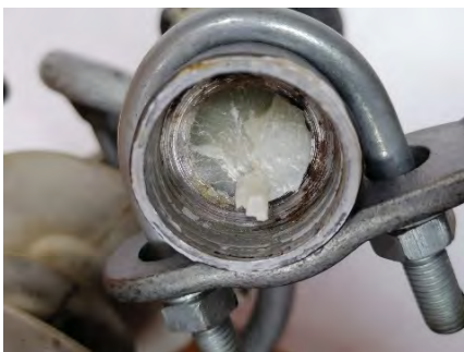
Рис. 8. Разрушения стеклопластикового сердечника под действием кислот (хрупкий излом)
