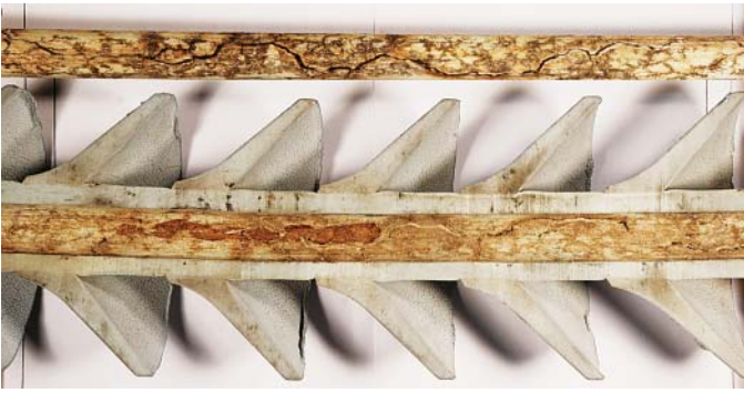
Разрез композитного изолятора, удалённого с опоры, иллюстрирующий образование внутренних треков на поверхности раздела стержня и резинового кожуха. Чтобы сделать эти треки видимыми, стержень был из кожуха удалён.
