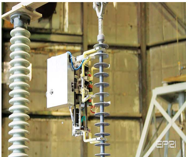
Демонстрационная модель самодвижущегося дефектоскопа, разработанная в институте EPRI. Дефектоскоп помещают на проверяемый участок изолятора изолирующей штангой, после чего он работает автономно.
