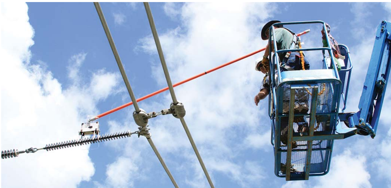
Полномасштабные испытания изоляторов с передачей информации по радиоканалу, выполняемые лабораторией EPRI в городе Леннокс, штат Массачусетс, США.
